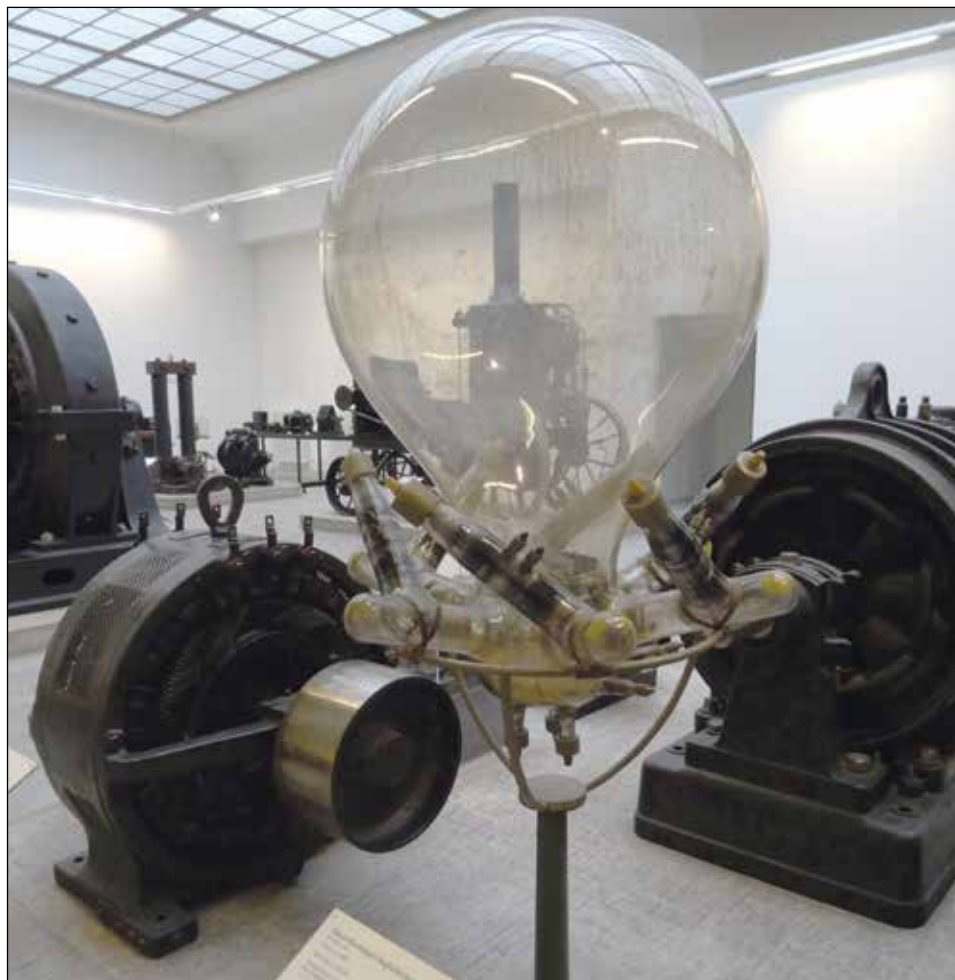
Kviksølv-dampensretter på Deutsches Museum i München. Det er en "komponent" på rundt regnet en meter i diameter fra AEG og fra 1936. Den kan ensrette op til 500A/600V på udgangen fordelt på seks anoder.
