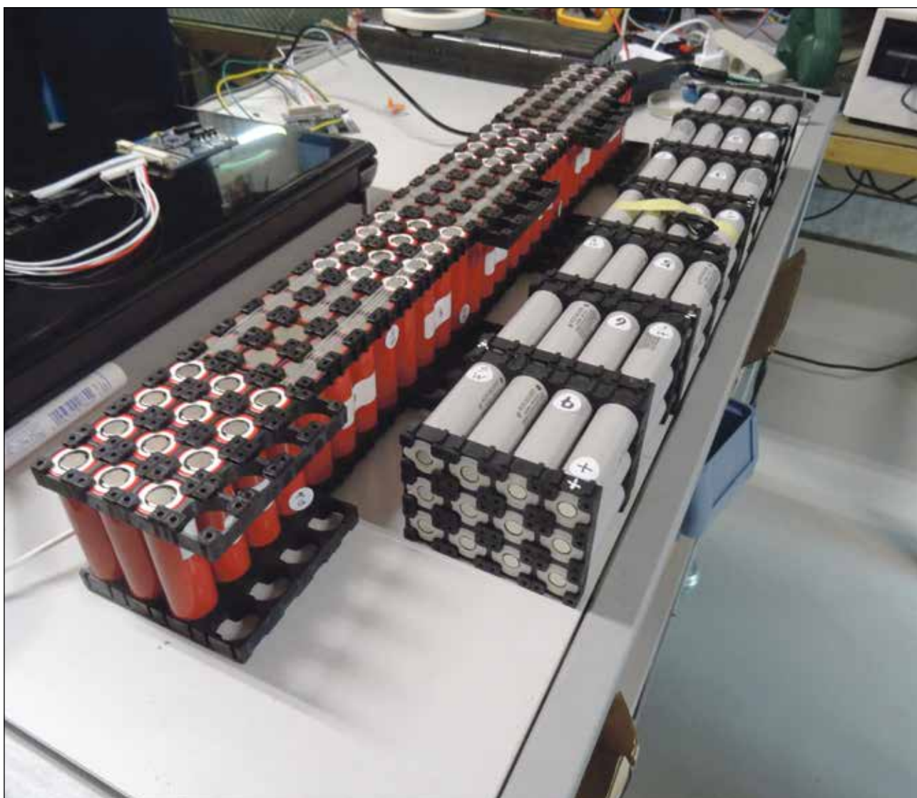
Pakning af mange litiumceller i en højenergiapplikation kræver viden om de mekaniske forhold. Cellerne må ikke røre hinanden, da det kan give kritiske termiske problemer. Actec kan hjælpe kunderne til udvikling af de bedst mulige batteriforsyninger baseret på det store erfaringsgrundlag, virksomheden har opnået gennem mange års arbejde med batterier og industrikunders applikationer.
